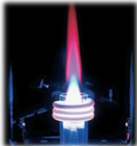
پلاسما، مجموعه‌ای از الکترون‌ها و یونهای مثبت گاز آرگون دارای انرژی بالا و دمایی در حدود ۱۰۰۰۰ درجه کلوین است. این محیط بوسیله امواج رادیویی با توان بالا ایجاد می‌شود. با تولید میدان امواج رادیویی، الکترون‌ها و یونهای پلاسما در مسیرهای مدور و خلاف جهت هم با شتاب خیلی بالا به حرکت در می‌آیند و اصطکاک ناشی از این برخورد تولید گرما (پلاسما) می‌کند.
