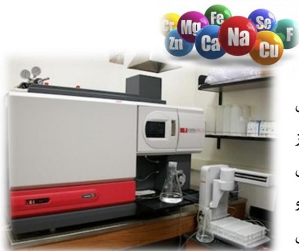
اسپکترومتری نشری پلاسمای جفت شده القایی-ICP (OES) یکی از مهمترین روش‌های دستگاهی آنالیز عنصری است. از این روش می‌توان برای اندازه‌گیری حدود ۷۰ عنصر از جدول تناوبی با حدود تشخیص در حد ppb در نمونه‌های مختلفی مانند نمونه‌های خاک، آب، فلزات، سرامیک‌ها و نمونه‌های آلی استفاده کرد. اساس این روش برانگیختگی الکترون‌های عناصر مختلف در محیطی به نام پلاسما و نشر نور
